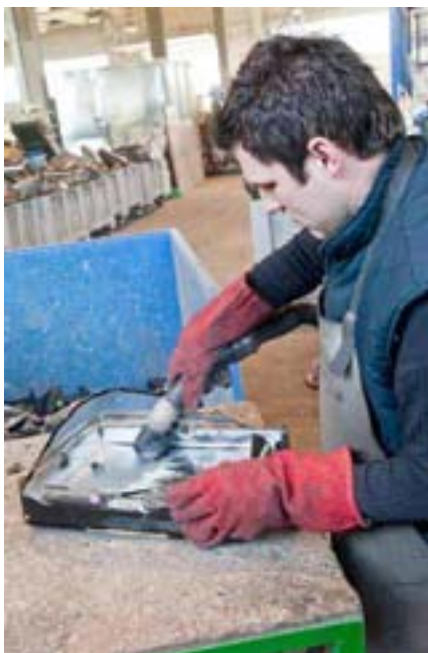
Odstranjivanje fosfora s unutarnje stjenke tv ekrana
