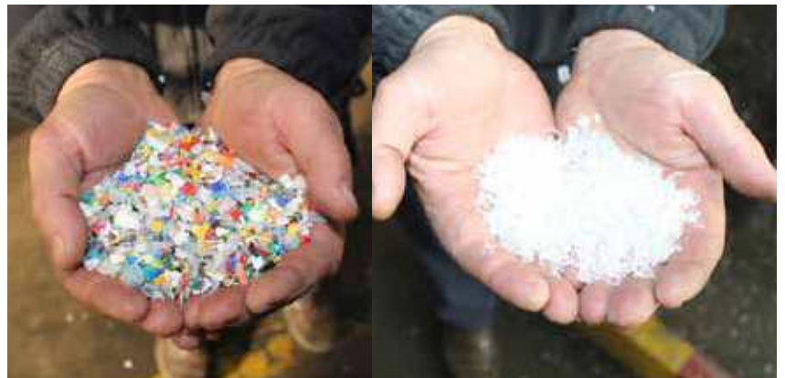
Usitnjavanjem stare plastične ambalaže dobiva se granulat (na slici) čijim topljenjem i ponovnim oblikovanjem dobivamo potpuno nove proizvode.
