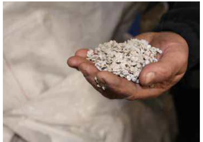
Granulat nastao usitnjavanjem otpadnog polietilena
