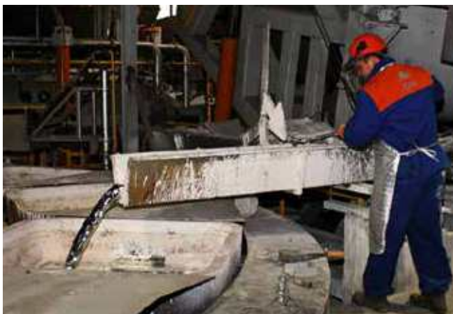
Ispuštanje lijeva iz peći
