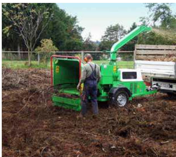
Prije kompostiranja granje se strojno usitnjava - sječkalica
