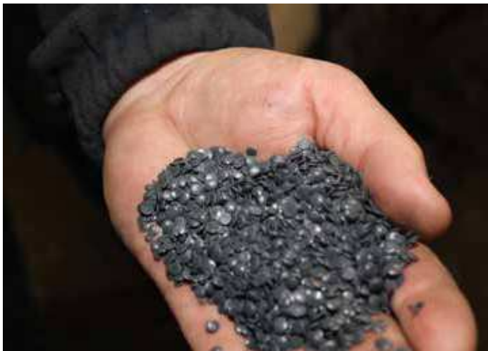
Granulat nastao usitnjavanjem otpadnog polietilena
