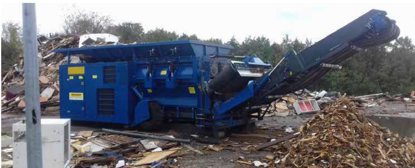
Drveni otpad usitnjava se specijalnim strojevima
