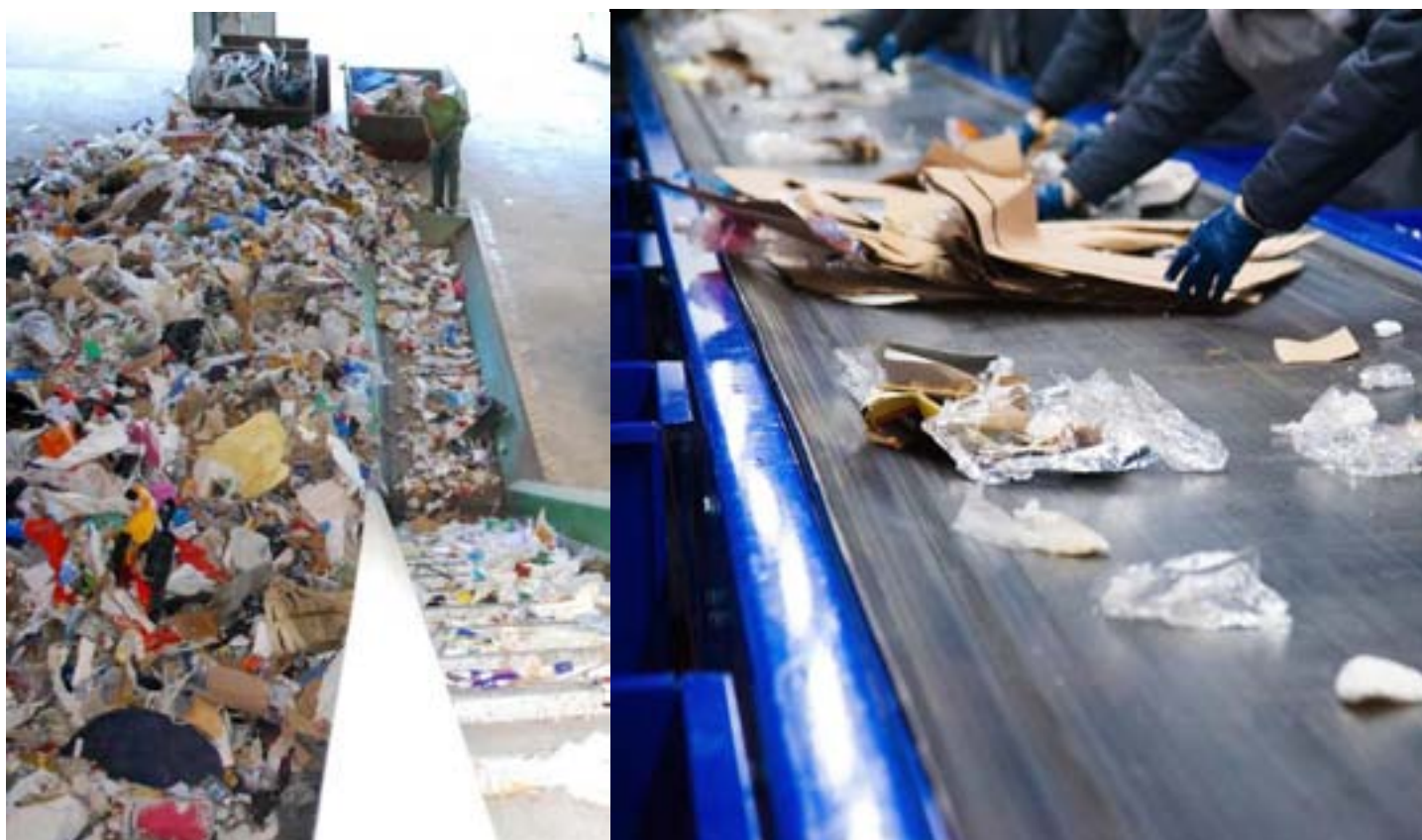
Dodatno odvajanje korisnih frakcija otpada
