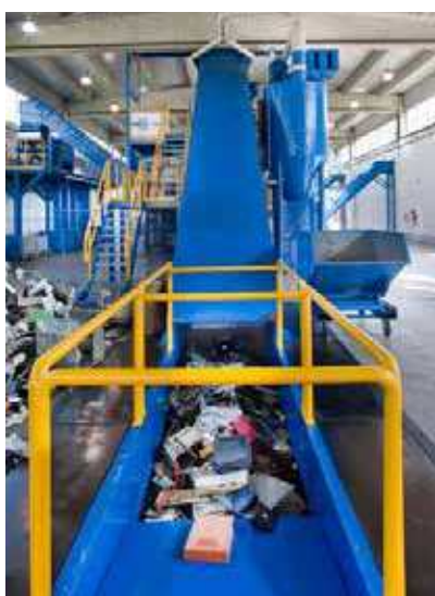
Stavljanje EE otpada u usitnjivač
